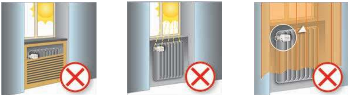
Рис. 8. Требования по размещению автоматического терморегулятора
